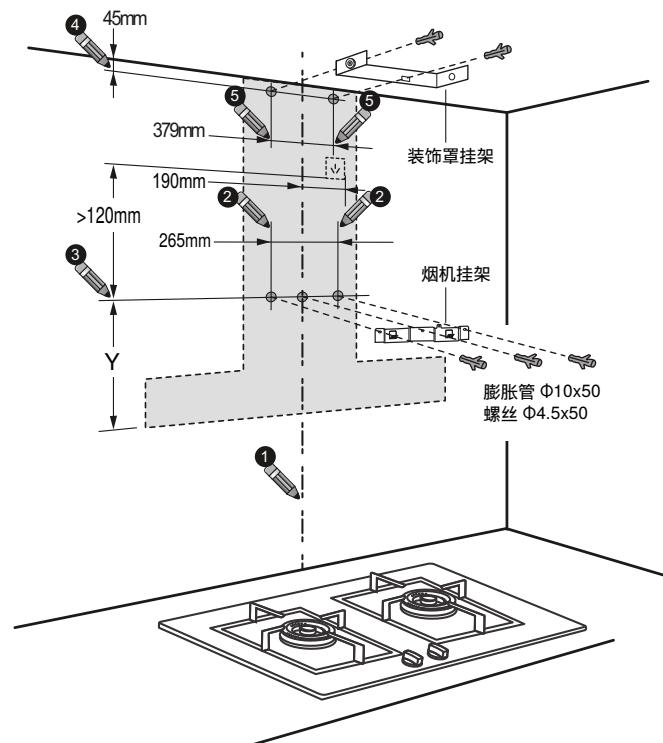
**提示：**尺寸 Y 的下沿是油烟机的最低点（不包含油杯）。
