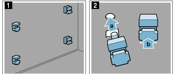
3. A l'arrière, accrocher le crochet de la fixation dans le trou supérieur **a** et la pousser dans le trou inférieur **b** (fig. **3**).
