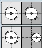
Zunanje in notranje kuhalisce s po dvema induktorjem lahko uporabljate neodvisno drug od drugega. Za vsako kuhalisce nastavite želeno stopnjo kuhanja. Priporočamo, da uporabljate le eno posodo na kuhalisce.
