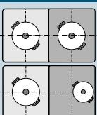
Зовнішня та внутрішня конфорки з двома індукторами на кожній можуть застосовуватися окремо одна від одної. Для цього встановіть для кожної з цих конфорок потрібний рівень нагрівання. Рекомендовано використовувати лише один посуд для приготування на конфорку.
