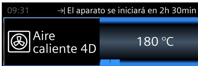
El horno permanece en modo de espera. El funcionamiento se inicia a la hora adecuada. En la línea de estado se ve el transcurso de la duración programada.
