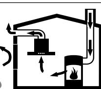
Hava dolaşımı ateşlikler (örneğin gaz, yağı, odun veya kömürle çalışan sobalar, şöfbenler, su ısıtıcıları) yanma havasını kurulum yerinden alırlar ve atık gazı bir atık gaz sistemi (örneğin baca kanalıyla dışarıya aktarırlar).
