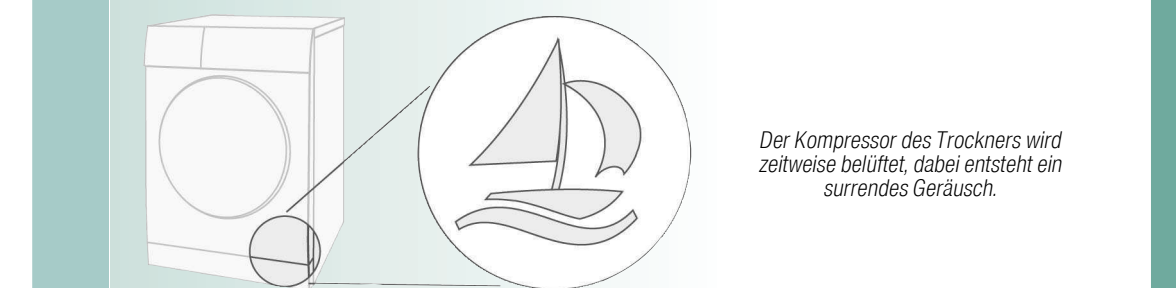
Der Kompressor im Trockner verursacht von Zeit zu Zeit ein Brummen. Lautstärke und Tonhöhe können sich dabei in Abhängigkeit der gewählten Programme und des Trocknungsfortschritts verändern.
