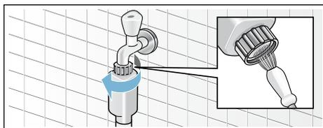
2. En los modelos estándar y Aqua-Secure, limpiar el filtro de la parte posterior del aparato: Retirar la manguera de la parte posterior del aparato. Extraer el filtro con ayuda de unos alicates y limpiarlo.
