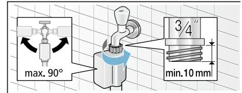
**Nota:** Abrir completamente la toma de agua y verificar la estanqueidad de los empalmes. La unión roscada se encuentra sometida a presión de agua.
