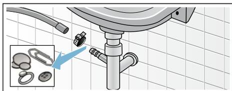
4. Encajar la manguera de evacuación y asegurar los puntos de empalme apretando la abrazadera para manguera.
