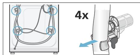
2. Soltar y retirar los 4 tornillos de fijación para el transporte. Retirar los seguros de transporte. Retirar para ello el cable de conexión de los soportes.
