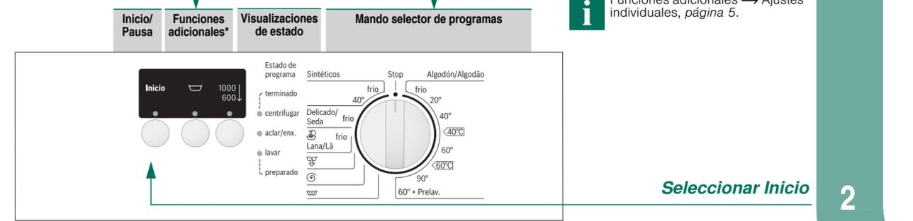
ⓘ Mando selector de programas para conectar y desconectar la máquina, y para seleccionar un programa de lavado. El mando se puede girar en ambas direcciones.
