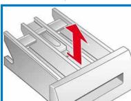
Mantener la cubeta abierta para permitir que el agua residual pueda secarse.
