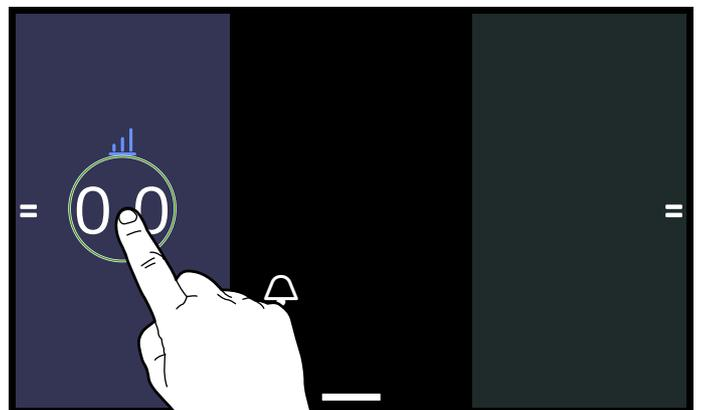
2. Sélectionnez le niveau de puissance en l'effleurant directement ou en faisant glisser votre doigt sur la réglette.
