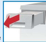
Se la spia (**Contenitore dell'acqua di condensa**) continua a lampeggiare anche dopo lo svuotamento → pulire il filtro presente nel contenitore dell'acqua di condensa, pagina 8/12.
