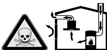
Vatrišta koja zavise od vazduha u prostoriji (npr. grejni uređaji na gas, ulje, drvo ili ugalj, protočni bojleri, kotlovi za zagrevanje vode) vazduh za sagorevanje crpe iz prostorije u koju su postavljeni i izdunve gasove izbacuju preko sistema za izdunve gasove (npr. kamoin) u spolašnju sredinu.
