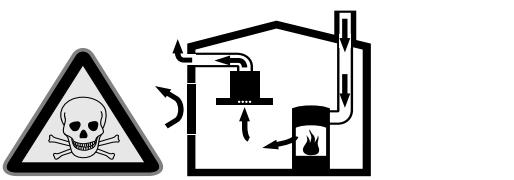
Kuhalnišča, ki so odvisna od prostorskega zraka (npr. grelne naprave na plin, olje, les ali oglje, pretocni grelniki, bojlerji), jemljejo zrak za izgorevanje iz prostora postavitve in odvajajo dim prek sistema za odvajanje dima (npr. napa) na prosto.
