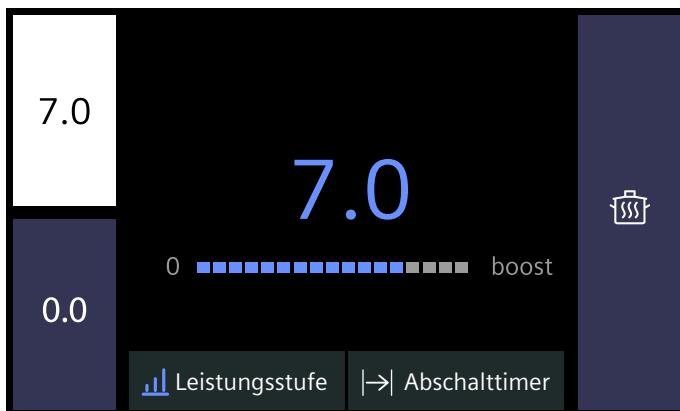
Im Einstellbereich einer Kochzone können Sie verschiedene Kochmodi und Leistungsstufen für die entsprechende Kochzone einstellen. Die Leistungsstufen ändern Sie durch direktes Berühren oder einer Wischgeste auf der Skala. Den Kochmodus wechseln Sie, indem Sie das Feld mit dem aktiven Kochmodus berühren.
