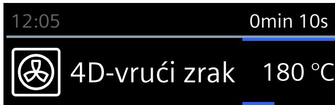
Na zaslonu se prikazuje namještena vrsta grijanja i temperatura.
