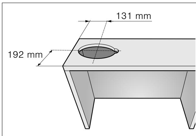
2. Retirar el panel inferior del armario si cuenta con él. Trazar los puntos de fijación en los interiores del armario y marcarlos con un buril. Para trazar los puntos de fijación, utilizar la plantilla adjunta. A
