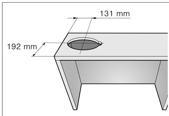
2. Remova o fundo do armário, se existente. Trace os pontos de fixação nos lados interiores do armário e perfure com um buril. Para traçar os pontos de fixação, utilize o molde fornecido. **A**
