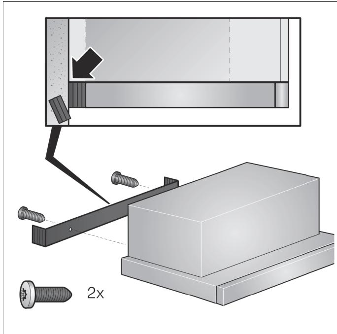
5. Volver a colgar el aparato, nivelarlo y atornillar. Apretar todos los tornillos con cuidado.
