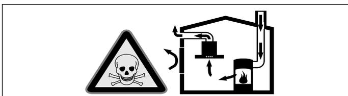
Зависимите от стайния въздух печки (напр. нагревателните уреди, работещи с газ, нафта, дърва или въглища, конвекторните нагреватели, калориферите) изтеглят въздух за изгаряне от мястото на поставяне и изкарват отработени газове през съоръжение за отработени газове (напр. димоотвод) на открито.
