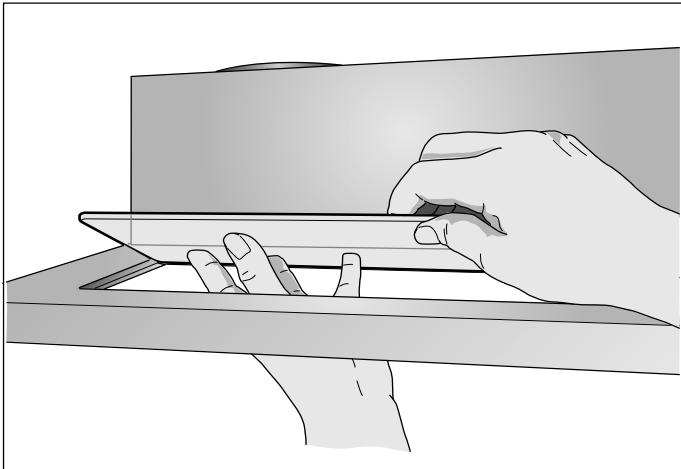
**Установка металлического жироулавливающего фильтра**
