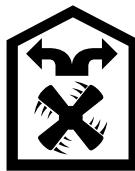
Васываемый воздух проходит через жироулавливающие фильтры и фильтр с активированным углём и очищенным выводится обратно в кухню.
