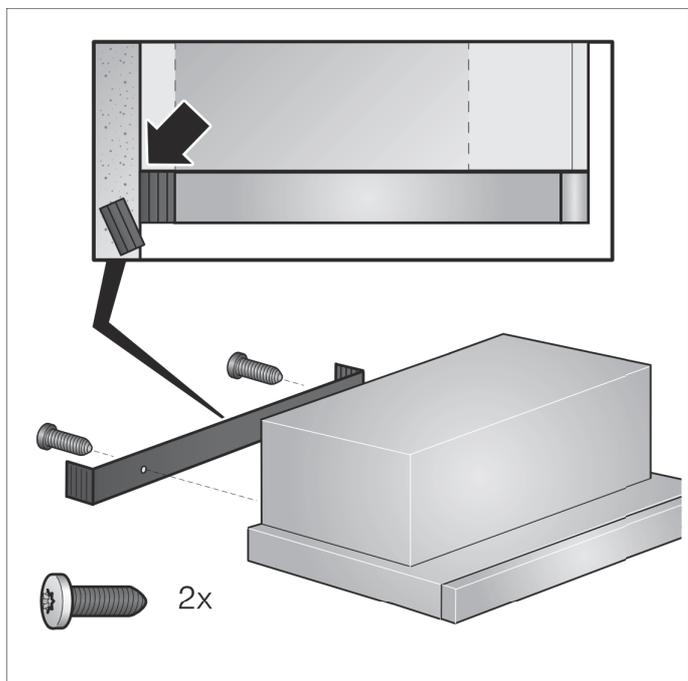
5. Raccrochez l'appareil, l'aligner et vissez-le fermement. Serrez toutes les vis avec précaution.
