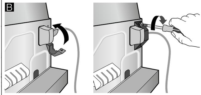
4. Vissez 2 équerres de fixation sur l'appareil. Attention à la position des vis. **C** Vissez alors les vis jusqu'à 8 mm de distance. **D**
