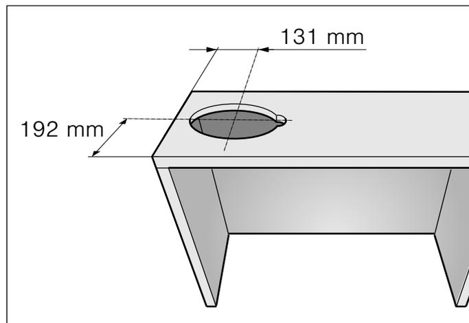
2. Si présent, retirez le fond du meuble. Tracez les points de fixation sur les parois intérieures du meuble et pré-percez-les avec un poinçon. Utilisez le gabarit joint pour tracer les points de fixation. **A**
