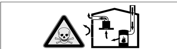
Les foyers à combustion alimentés en air ambiant (par exemple appareils de chauffage, au gaz, au bois, au fioul ou au charbon, les chauffe-eau, chauffe-eau accumulateurs) prélèvent l'air de combustion dans la pièce où ils sont installés et rejettent les gaz de fumée à l'extérieur par le biais d'un système spécifique (cheminée par exemple).
