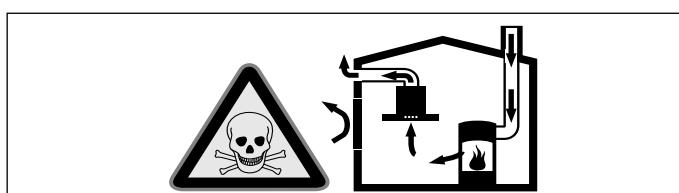
Huoneilmaa tarvitsevat tulisijat (esim. kaasu-, öljy-, puu- tai hiilikäyttöiset lämmityslaitteet, läpivirtauskuumennin, vedekuumennin) ottavat polttoilman huonetilasta ja johtavat poistoilman poistoilmalaitteen (esim. savutorven) kautta ulos.
