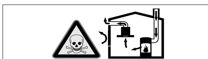
Ildsteder som er avhengig av romluft (f.eks. varmeapparater som drives med gass, olje eller kull, varmtvannsberedere) bruker forbrenningsluften fra oppstillingsrommet og leder avgassene gjennom et avgassanlegg (f.eks. pipe) i det fri.
