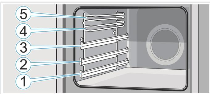
In den Einschubhöhen 4 und 5 das Zubehör immer zwischen die beiden Führungsstäbe einer Einschubhöhe schieben.
