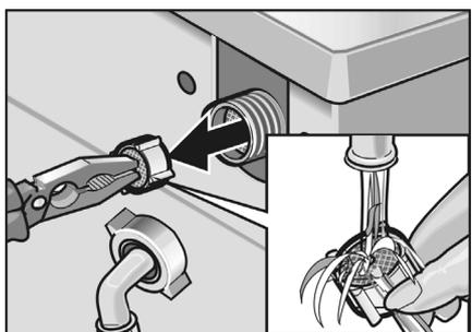
Si la lavadora no recibe el agua necesaria, eliminar la presión de agua del tubo de alimentación:
