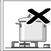
Stellen Sie das Kochgefäß mittig über den Brenner, sonst kann das Gefäß umkippen. Stellen Sie große Töpfe nicht auf die Brenner in der Nähe der Armaturen. Diese könnten überhitzt und dadurch beschädigt werden.
