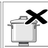
Stellen Sie die Töpfe auf die Roste, niemals direkt auf die Brenner. Vergewissern Sie sich vor der Benutzung, dass die Topfroste und die Deckel der Gasbrenner korrekt aufliegen.
