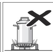
Gebruik pannen met een geschikte maat voor elke brander. Gebruik geen kleine pannen op grote branders. De vlam mag de zijkanten van de pan niet raken.
