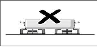
Μην χρησιμοποιείτε δυο καυστήρες ή πηγές θερμότητας μόνο για ένα σκεύος. Αποφύγετε τη χρήση των πλακών ψησίματος, πηλίνα σκεύη, κτλ. για πολύ ώρα στη μέγιστη ισχύ.
