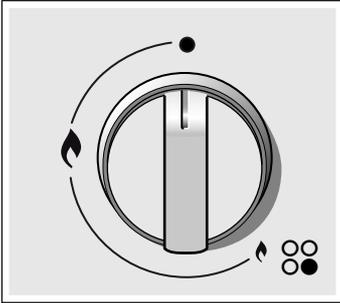
Para un correcto funcionamiento del aparato es imprescindible asegurarse de que las parrillas y todas las piezas de los quemadores estén bien colocadas. No intercambie las tapas de los quemadores.
