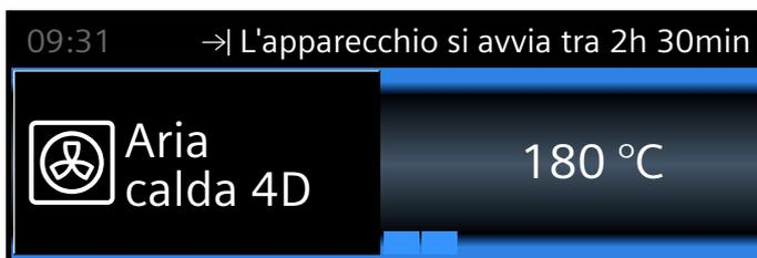
Il forno è in modalità standby. Il forno entra in funzione all'ora prestabilita. Sulla barra di stato viene visualizzato lo scorrere della durata.
