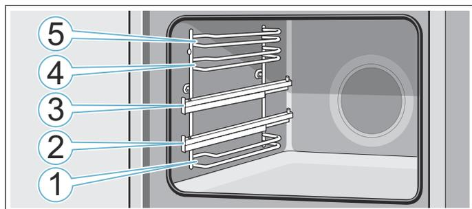
Ai livelli di inserimento 1, 4 e 5, inserire l'accessorio sempre tra entrambe le aste guida di un livello di inserimento.
