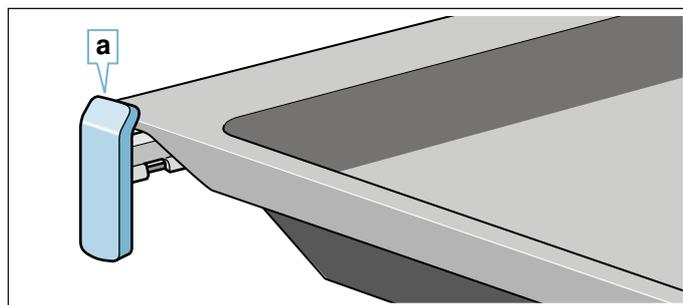
Le guide di estensione si innestano quando sono estratte del tutto. In questo modo si può sistemare agevolmente l'accessorio. Per sbloccarle, spingere indietro con una leggera pressione le guide di estensione nel vano di cottura.
