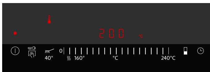
Kada je postignuta podešena temperatura, javlja se zvučni signal, a indikator zagrijavanja se gasi. Sada možete položiti namirnice za pečenje na ploču.
