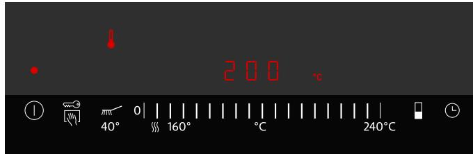
Kada se postigne podešena temperatura, onda se oglašava zvučni signal, a prikaz zagrevanja se gubi. Sada možete da stavite namirnicu za prženje.
