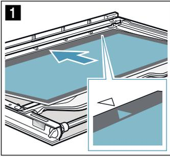
2. Presionar el cristal intermedio en la zona **a** hacia abajo, insertar el soporte **b** en posición inclinada y presionar hasta que encaje (figura 2). El soporte está colocado (figura 3).
