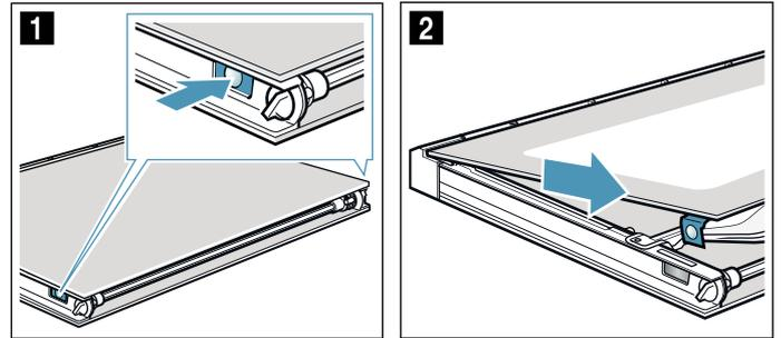
5. Presionar el cristal intermedio en la zona **a** hacia abajo, levantar con cuidado el soporte **b** hasta que se pueda extraer (figura 3).
