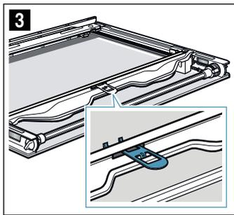
3. Insertar los cristales interiores derecho e izquierdo en el soporte **c** (figura 4).
