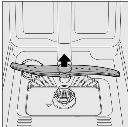
4. Sprüharme unter fließendem Wasser reinigen.
