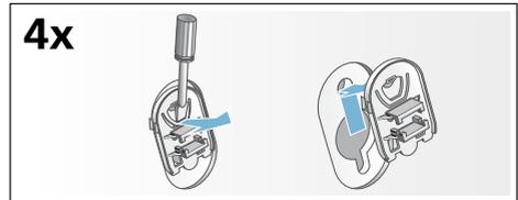
2. Mettre les 4 douilles en place. Fixer fermement le cordon d'alimentation électrique aux fixations. Mettre les vis des cales de transport en place et les serrer à l'aide d'une clé plate SW13.
