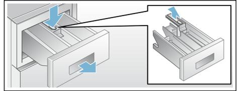
3. Avec de l'eau et une brosse, nettoyer le bac à lessive et l'insert, puis le sécher. Nettoyer le boîtier aussi à l'intérieur.
