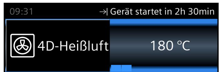
Der Backofen ist in Warteposition. Der Betrieb startet zum richtigen Zeitpunkt. Die Dauer läuft sichtbar in der Statuszeile ab.
