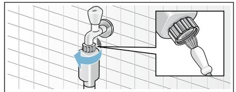
2. Nei modelli Standard e Aqua-Secure pulire il filtro nella parte posteriore dell'apparecchio: Svitare il tubo flessibile dal lato posteriore dell'apparecchio, Estrarre il filtro con la pinza e lavarlo.
