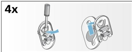
2. Inserire tutte le 4 boccole. Fissare il cavo di alimentazione nei fermi. Reinscrivere le viti dei blocchi per il trasporto e fissarle con una chiave inglese da 13.
