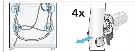
2. Svitare e rimuovere tutte le 4 viti dei blocchi per il trasporto con una chiave inglese da 13. Rimuovere le boccole. Staccare il cavo di alimentazione dai fermi.
