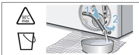
5. Svitare con cautela il coperchio della pompa, l'acqua residua può fuoriuscire. Pulire l'interno, la filettatura del coperchio di pompa e il corpo della pompa. L'elica della pompa di scarico dell'acqua deve poter girare liberamente. Applicare di nuovo il coperchio della pompa e serrarlo a fondo. L'impugnatura deve essere in posizione verticale.
