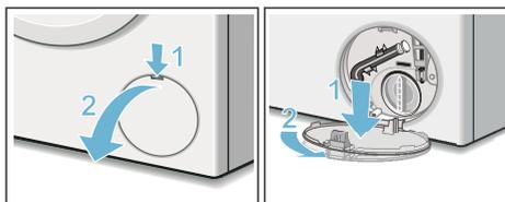
4. Staccare il raccordo flessibile dal suo alloggiamento per lo svuotamento di emergenza. Estrarre il tappo di chiusura. Fare scorrere l'acqua in un idoneo contenitore. Applicare il tappo di chiusura e ricollocare il raccordo flessibile nel suo alloggiamento.
