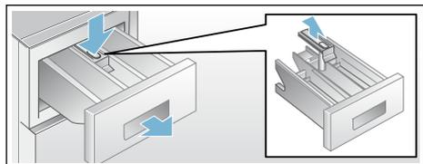
3. Lavare la vaschetta detersivo e l'inserto con acqua e una spazzola e asciugarli. Pulire anche l'interno dell'alloggiamento.
