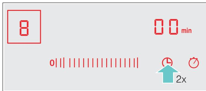
2. Натисніть бажану попереднє налаштування в зоні регулювання параметрів. Можливі попередні налаштування зліва направо: 1, 2, 3 і т. д. до 9 хвилин. Протягом наступних 10 секунд водіть пальцем по зоні регулювання параметрів, доки не буде встановлено потрібну тривалість.
