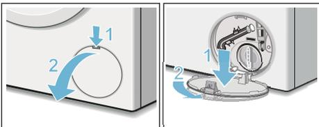
4. Entleerungsschlauch aus der Halterung nehmen.
