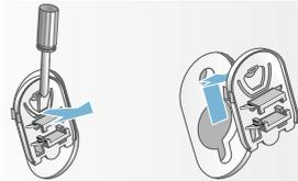
2. Alle 4 Hülsen einsetzen. Netzleitung an den Halterungen festklemmen. Schrauben einsetzen und festziehen.
