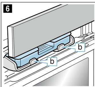
9. Poussez lentement le bandeau vers le bas, puis vers l'arrière jusqu'à ce qu'il soit entièrement fermé. Le réservoir d'eau est rempli. Vous pouvez démarrer des modes avec de la vapeur.
