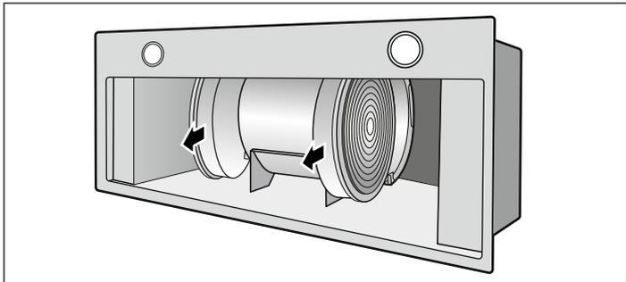
3. Stavite filter s aktivnim ugljenom preko motora.
