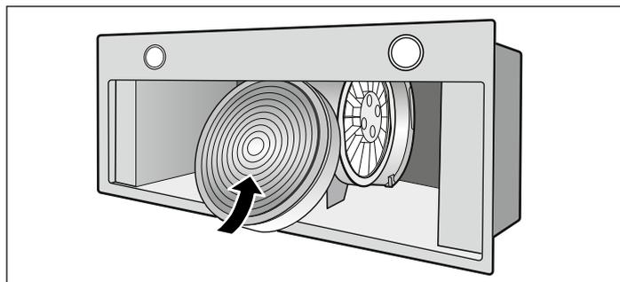
2. Stavite filter s aktivnim ugljenom preko motora.
