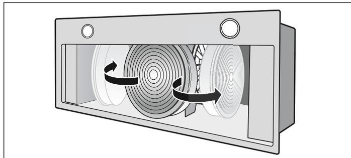
3. Oprezno stavite filter s aktivnim ugljenom u držač.
