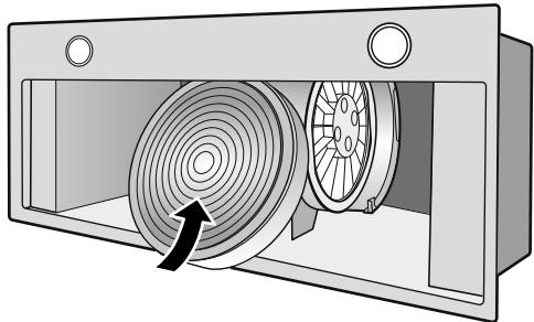
**2.** Stavite filter s aktivnim ugljenom preko motora.
