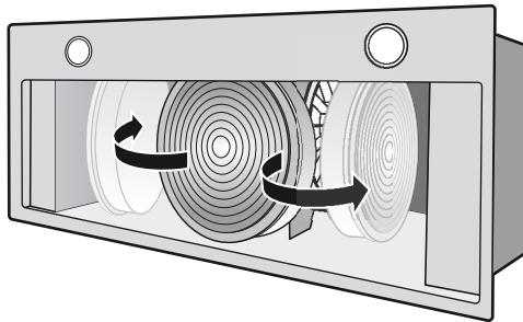
**3.** Oprezno stavite filter s aktivnim ugljenom u držač.
