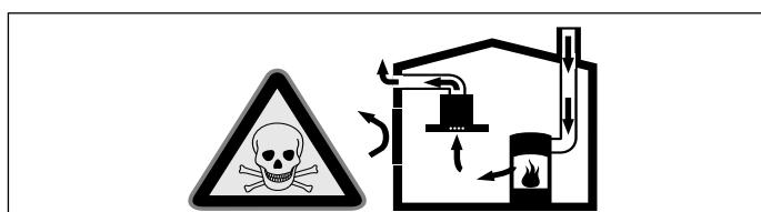
Grijala na plamen koja ovise o zraku iz prostorije (npr. plinska grijala, grijala na ulje i drva ili ugljen, protočni grijaci vode, uređaji za pripremu tople vode) troše zrak za sagorijevanje iz prostorije u kojoj je postavljen uređaj i odvode dimne plinove kroz dimovodne uređaje (npr. dimnjak) na otvoreno.
