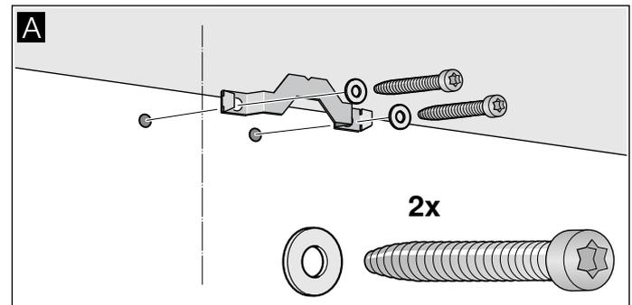
2. Avvitare saldamente le sospensioni per la cappa di aspirazione. Non stringere le viti! **B**
