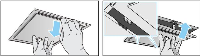
Bei Zusatzfiltern im Innenraum, Verriegelung öffnen und den Metallfettfilter herunterklappen. Dabei mit der anderen Hand unter den Metallfettfilter fassen.
