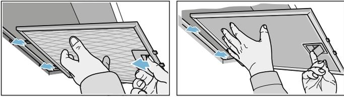
Bei Randabsaugungsfiltern, den Metallfettfilter nach unten ziehen. Dabei mit der anderen Hand unter den Metallfettfilter fassen.
