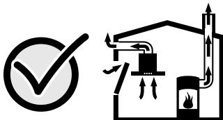
Du bør i alle fall rádføre deg med skorsteinsfeieren, som kan bedømme husets tilførselsluft og avtrekksluft og foreslår passende tiltak for ventilasjonen. Hvis ventilatoren utelukkende benyttes i sirkulasjonsdrift, kan den brukes uten begrensninger.
