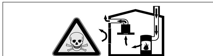
Ildsteder som er avhengig av romluft (f.eks. varmeapparater som drives med gass, olje eller kull, varmtvannsberedere) bruker forbrenningsluften fra oppstillingsrommet og leder avgassene gjennom et avgassanlegg (f.eks. pipe) i det fri.
