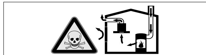
Huoneilmaa tarvitsevat tulisijat (esim. kaasu-, öljy-, puu- tai hiilikäyttöiset lämmityslaitteet, läpivirtauskuumennin, vedenkuumennin) ottavat polttoilman huonetilasta ja johtavat polttoilman poistoimalaitteen (esim. savutorven) kautta ulos.
