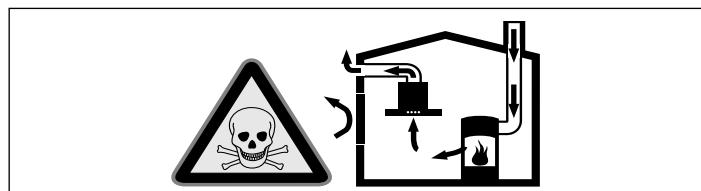
Eldstäder som är beroende av rumsluft (t.ex. värmearrapparater som drivs med gas, olja, ved eller kol, genomströmningsapparater, varmvattenberedare) tar sin förbränningsluft ur det utrymme där enheten är installerad och leder ut avgaserna i det fria via en avgasanläggning (t.ex. skorsten).
