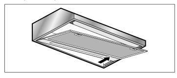
4. Drähte entfernen und Vlies-Fettfilter entnehmen.
