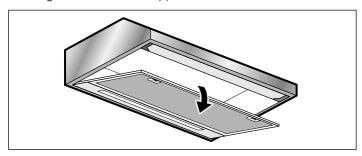
3. Filtergitter schräg positionieren und abnehmen.
