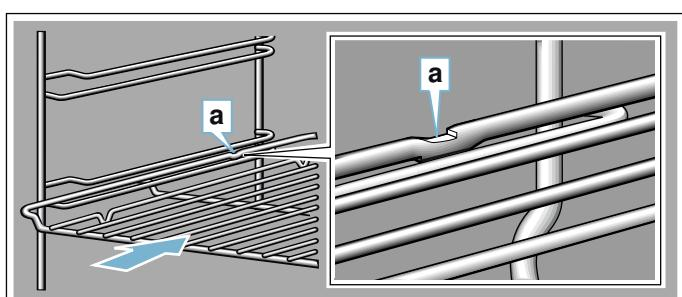
插入烤盘时，确保凸耳 **a** 位于后方且朝下。附件 **b** 的倾斜边缘必须朝向电器门。
