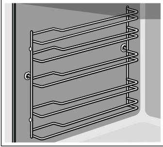
1. 稍微抬起导轨前端 **a**，将其拆下 **b** (图 **1**)。
