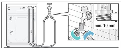
**Указание:** Осторожно откройте водопроводные краны и проверьте герметичность в местах соединений. Резьбовое соединение находится под давлением водопроводной воды.
