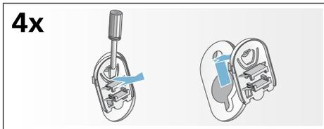
2. Вставьте все 4 втулки. Зафиксируйте сетевой кабель в креплениях. Вставьте винты и затяните их.
