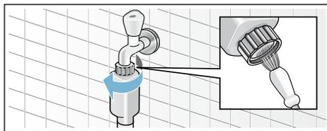
6. Для стандартных моделей и моделей с системой Aqua-Secure: очистите сетчатый фильтр на задней стенке прибора: отсоедините шланг от задней стенки прибора; извлеките фильтр с помощью плоскогубцев и прочистите его.
