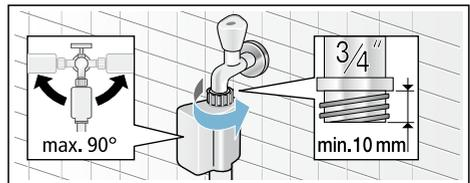
**Указание:** Осторожно откройте водопроводный кран и проверьте герметичность в местах соединений. Резьбовое соединение находится под давлением водопроводной воды.
