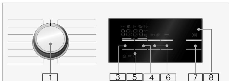
**1 Переключатель программ:** для выбора программы, а также для включения/выключения стиральной машины (положение **Выкл. (Off)**); обзор всех программ содержится во вкладыше к инструкции об эксплуатации и установке.
