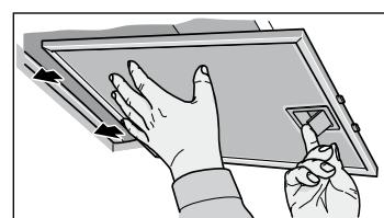
U filtrů s obvodovým odsáváním vytáhněte kovový tukový filtr dolů. Při tom přidržte kovový tukový filtr zespodu druhou rukou.
