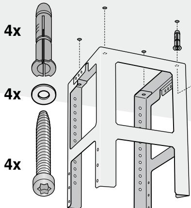
4. Pre upevnenie vyvŕtajte štyri otvory s Ø 8 mm a hĺbkou otvoru 80 mm a zatlačte do nich hmoždinky až do úrovne steny.
