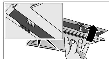
U přídavných filtrů ve vnitřním prostoru odjistěte aretaci a kovový tukový filtr vyklopte dolů. Při tom přidržte kovový tukový filtr zespodu druhou rukou.
