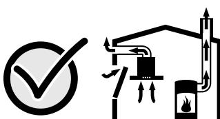
Ohniská závislé od vetrania miestnosti (napr. vyhrievacie prístroje na plyn, olej, drevo alebo uhlíe, prietokové ohrievače, ohrievače vody) odoberajú dymové plyny z miestnosti, kde sú nainštalované a odvádzajú ich odsávacím zariadením (napr. komín) von.
