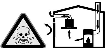
Uzavřené spotřebiče paliv (např. tepelné spotřebiče na plyn, olej, dřevo nebo uhlí, průtokové ohříváče, bojlerы) odebírají spalovací vzduch z místnosti, ve které jsou nainstalované, a spaliny odvádějí zařízením pro odvod spalin (např. komínem) ven.
