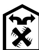
Nasávaný vzduch sa v tukovom filtri a filtri s aktívnym uhlím prečistí a znova sa vráti do kuchyne.
