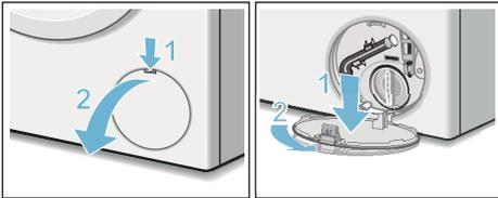
4. Extraer el tubo auxiliar de desagüe de su soporte. Retirar el tapón de cierre y recoger el agua de lavado en un recipiente adecuado. Encajar el tapón de cierre en el tubo de desagüe y colocarlo en su soporte.
