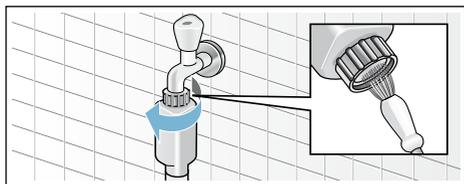
6. En los modelos Estándar y Aqua-Secure, limpiar el filtro de la parte posterior del aparato: Retirar la manguera de la parte posterior del aparato. Extraer el filtro con ayuda de unos alicates y limpiarlo.
