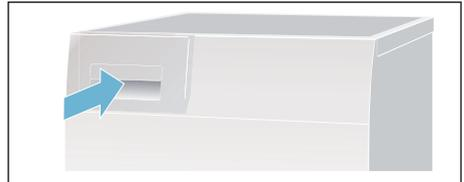
**Nota:** El filtro ubicado en el recipiente de agua de condensación filtra el agua de condensación que se utiliza para la limpieza automática de la secadora. El filtro se limpia al vaciar el agua de condensación. No obstante, es necesario comprobar periódicamente el filtro y eliminar los posibles residuos que se hayan podido acumular. Ver → *Página 35*.
