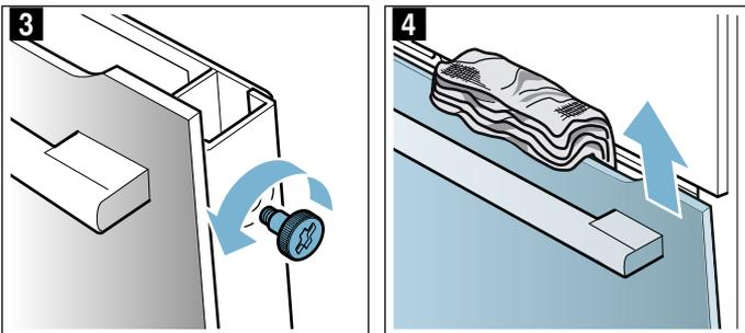
Reinigen Sie die Scheiben mit Glasreiniger und einem weichen Tuch.
