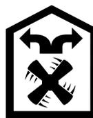
Zassane powietrze jest czyszczone przez filtr przeciwtłuszczowy oraz filtr z węglem aktywnym i z powrotem kierowane do kuchni.
