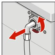
Retirez le flexible au dos de l'appareil.
