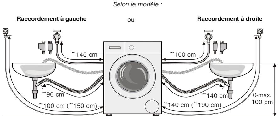
**i** En cas d'utilisation des portes-flexible, les longueurs de flexible possibles diminuent !
