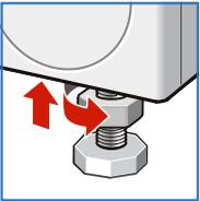
3. Serrez le contre-écrou contre le capot de l'appareil. Ce faisant, retenez fermement le pied et ne modifiez pas sa hauteur.
