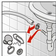
2. Détachez le collier du flexible, retirez prudemment le flexible d'écoulement.
