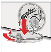
4. Sortez le flexible de vidange de sa fixation. Retirez la coiffe d'obturation, laissez le bain lessiviel s'écouler dans un récipient adéquat.
