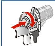
Bridez fermement le cordon d'alimentation électrique contre les fixations. Mettez les vis en place et serrez-les à fond.
