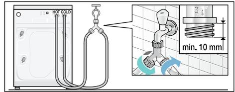
**Avvertenza:** Aprire con cautela i rubinetti dell'acqua e controllare eventuali perdite degli allacciamenti. Il raccordo a vite è sottoposto alla pressione delle condutture dell'acqua.
