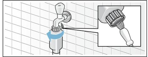
6. Nei modelli Standard e Aqua-Secure pulire il filtro nella parte posteriore dell'apparecchio: Svitare il tubo flessibile dal lato posteriore dell'apparecchio, Estrarre il filtro con la pinza e lavarlo.
