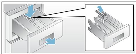
3. Lavare la vaschetta detersivo e l'inserito con acqua, spazzolarli e asciugarli. Pulire anche l'interno dell'alloggiamento.
