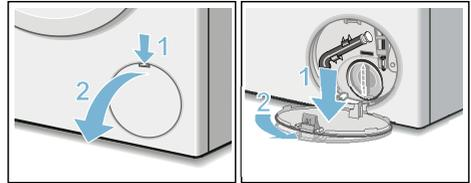
4. Staccare il raccordo flessibile dal suo alloggiamento per lo svuotamento di emergenza. Estrarre il tappo di chiusura. Fare scorrere l'acqua in un idoneo contenitore. Applicare il tappo di chiusura e ricollocare il raccordo flessibile nel suo alloggiamento.
