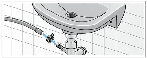
■ **Raccordo di scarico a muro con manicotto in gomma oppure libero scarico nel pozzetto**
