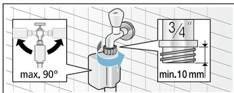
**Avvertenza:** Aprire con cautela il rubinetto dell'acqua e controllare eventuali perdite degli allacciamenti. Il raccordo a vite è sottoposto alla pressione delle condutture dell'acqua.
