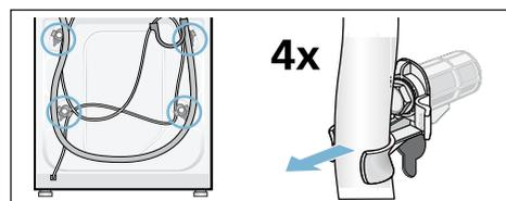
2. Svitare e rimuovere tutte le 4 viti dei blocchi per il trasporto. Rimuovere le boccole. Staccare il cavo di alimentazione dai fermi.
