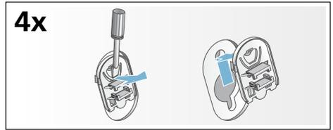
2. Inserire tutti i 4 blocchi. Fissare il cavo di alimentazione nei fermi. Inserire e stringere le viti.
