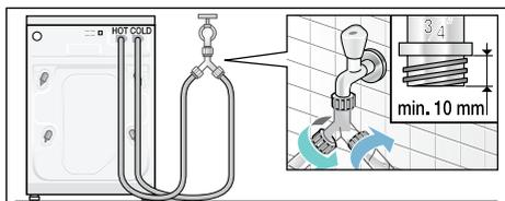
**Avvertenza:** Aprire con cautela i rubinetti dell'acqua e controllare eventuali perdite degli allacciamenti. Il raccordo a vite è sottoposto alla pressione delle condutture dell'acqua.
