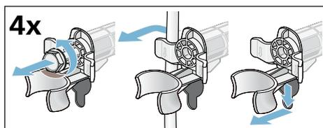
3. Applicare le coperture. Bloccarle saldamente premendo sul gancio di fermo.
